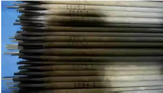
Gambar 5. Elektroda sebagai bahan Pengelasan
